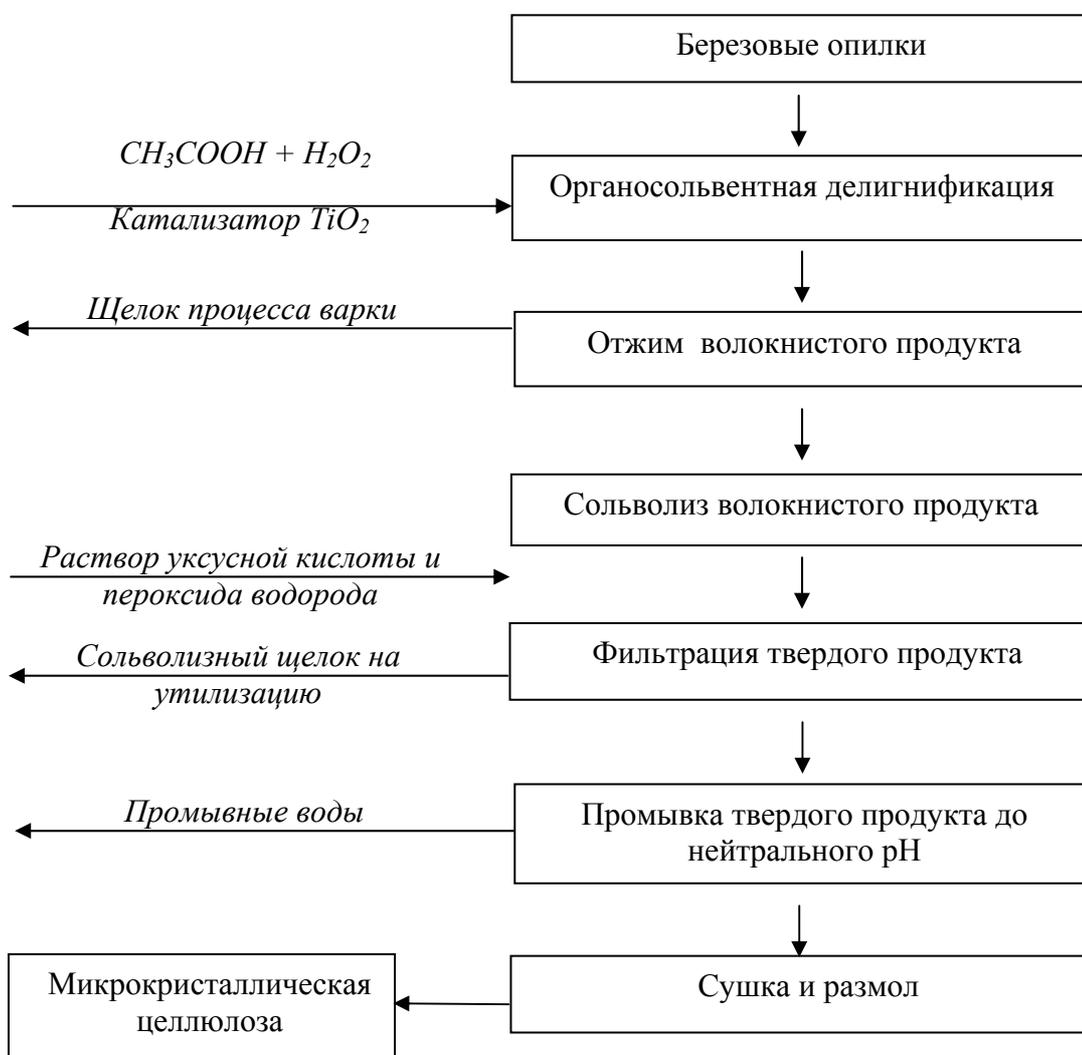
Рис. 4. Схема получения МКЦ из древесных опилок
